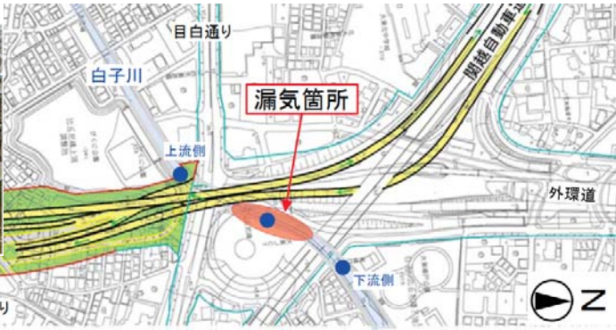
白子川護岸の水抜き孔や目地を通じ発生
