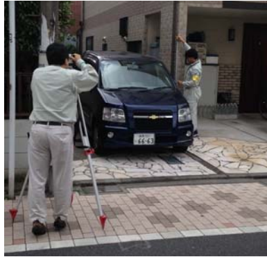
家屋の基礎高の測量
