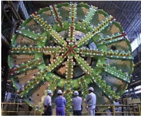
直径16.1メートルのシールドマシン。杉並区内大深度地下を掘削するもの。朝日新聞2016年9月15日付けより。
