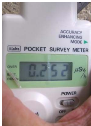
0.252 \mu\text{Sv/h} の値も 測定器はアロカ社「ALOKA PDR-101型 ポケットサーベイメーター」
